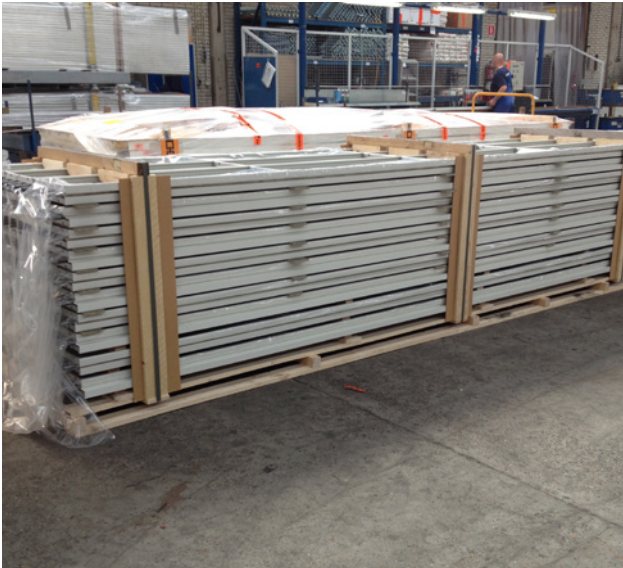
Transporteenheid (Maximaal 20 gestapelde panelen per pallet.)
