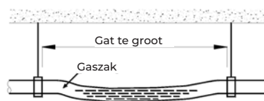
Afbeelding 7.4 Effect van onvoldoende ondersteuning van afvoerleidingen
