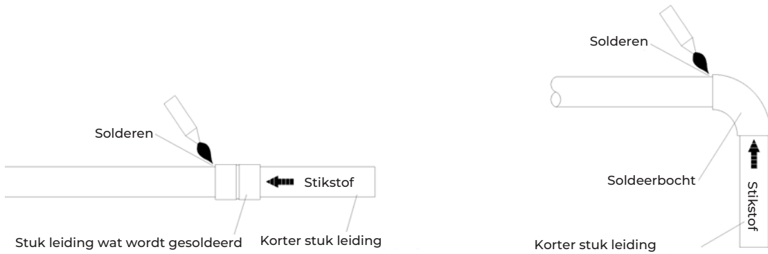
Afbeelding 6.5 Stromende stikstof vanaf de korte kant tijdens het hardsolderen
